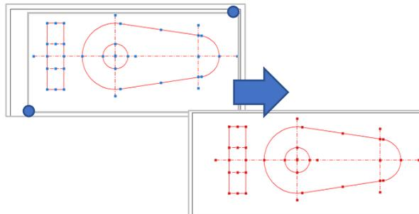
A点をクリックし、続いてB点をクリックすると、図形全体が移動します。
