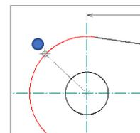
「終点を指示してください」とメッセージに出ますがクリック等はせずにEnterキーを押してください。ちょうど円弧上まで寸法線を引いてくれます。
