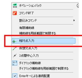
メッセージバーが「相対原点を指示してください」に変わるので、用紙枠左下（座標原点）を交点サーチしてクリックします。
