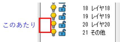
ペンのマークが電球の横に表示されたら、レイヤの指定は完了です。マウスをレイヤのビュー外に移動させると、ビューは自動的に閉じます。
