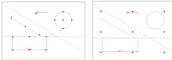
右側のようにハンドルが選択図形を囲むように9点ある場合、最大外形上の8点をクリックすると図形全体を拡大/縮小できます。この時Shiftキーを併用すると縦横比を保持できます。
