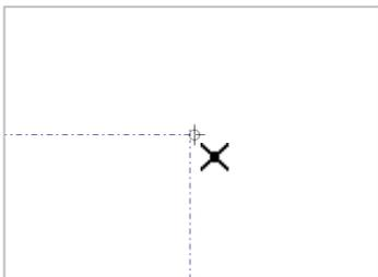
相対点入力ボックスが表示されるので、 $-10,-10$  と入力しEnterを押します。用紙枠右上から縦横 10mm内側に長方形が作図されます。
