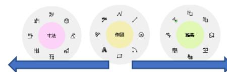
リング内のコマンドは[ツール]-[ツール設定]内の[リングメニュー]で設定できます。設定後は必ず[ツール設定]ダイアログの[保存]を実行して初期値を保存ください。
