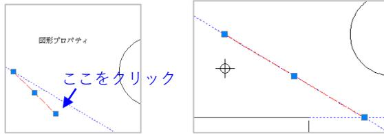
同じように線分の中心のハンドルをクリックします。線分がマウスの動きに従って移動し、クリックした点で確定します。配置時にCtrlキーを同時に押していると複製されます。
