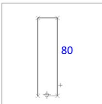
最後に右クリックメニューを起動し【ループを閉じる】をクリックすると、長方形が作図されます。
