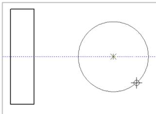
中心点が確定すると、「円周上の点または半径を指示してください」と表示され、マウスに合わせて円が拡縮します。この状態でマウスの右クリックメニューを表示してください。
