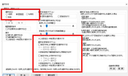
「選択法」が「窓指定」または「自由」になっている時に、選択方向によって選択の挙動が変わります。
