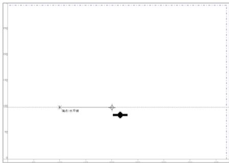
点線上にマウスをあてると、線上点をサーチするので目分量でX: 200程度の位置でクリックします。線上点サーチにより水平線が作図されました。
