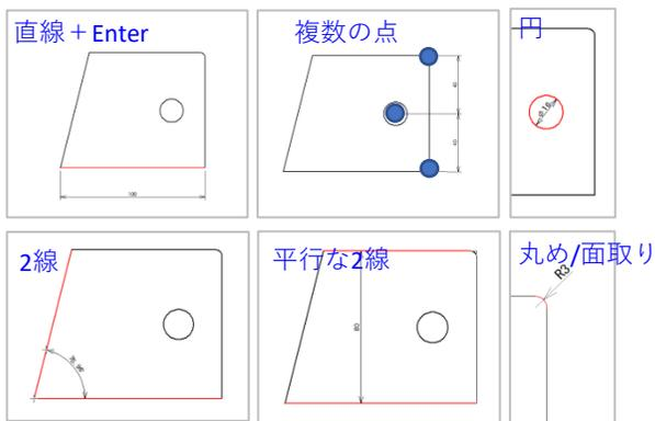
まずは「体験用ツール」から「寸法図形指定」コマンドを実行し、水平寸法を作図します。
