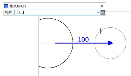
マウスの右クリックメニューを表示して、「直径指定」をクリックしてチェックを外してください。
