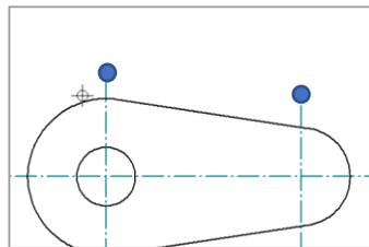
「通過点または長さを指示してください」と表示されるので、左側の水平寸法の端点の上にマウスを通し、ガイドを表示させてから、ガイド上でクリックします。
