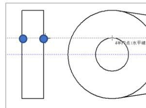
続いて同じ円の下部の四半円 (時計の6時の位置) にマウスを持ってくると、端点サーチされるので、その点からマウスを左に移動させガイドを表示します。
