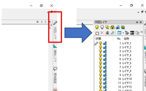
例では20番レイヤに図面枠を書くので、20番レイヤの電球の左側をクリックします。
