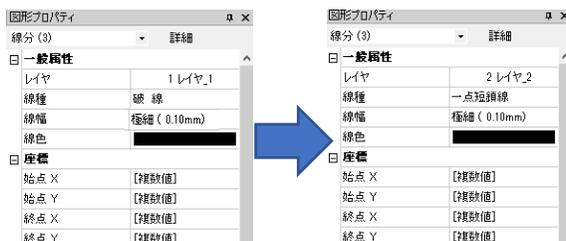
「図形プロパティ」の変更が完了したら、Escキーを押すか、マウスの右ボタンと左ボタンを同時クリックすると選択状態が解除されます。
