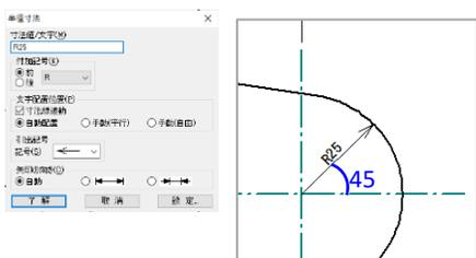
次の直径寸法の作図のために設定を切り替えます。右クリックメニューから [円] の上にマウスを持っています。表示されるサブメニューで [直径寸法] をクリックしてください。
