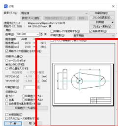
プレビューに印刷イメージがすべて収まっていない場合は、[プリンタ設定] をクリックし、用紙を「A4」、用紙の向きを「横」に設定し [OK] をクリックします。
