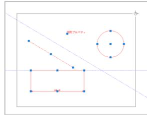
ハンドル以外の赤くなっている部分をドラッグすると図形を移動 (Ctrl併用で複製) できます。
