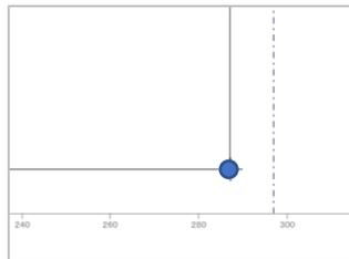
メッセージバーに「対角点を指示してください」と表示されるので、キーボードから  $X:-100 Y:30$  と相対点入力すると、長方形右下から内側に 長辺100 短辺30の長方形が作図されます。
