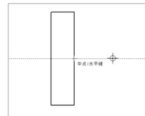
ガイドが表示されている状態で、Zキーを押すと、中心を通る補助線が作図されます。
