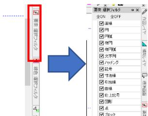
今回は複数ある図形の中から線分要素だけを選択したいので、まず「全OFF」をクリックしてすべての選択を解除した後で「直線」にチェックを付けます。
