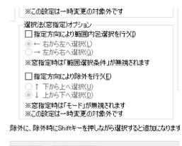
「指定方向により範囲内包選択をおこなう」をチェックし方向を設定すると、選択方向により図形がすべて範囲内に収まる時のみ選択できるようになります。
