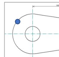
「方向点又は角度を指示してください」と表示されるので、まずはクリックして方向点を確定します。寸法線を引きたい方向に仮想線が表示されたらクリックします。例では左斜め上45度程度の点でクリックします。
